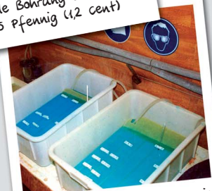
Die „Ätz-Anlage“ (hier schon in der dritten Generation)
