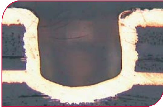
Blind Via mit zylindrischem Werkzeug
