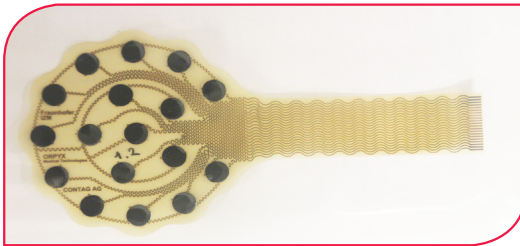
Pflasterpatch mit Drucksensoren
