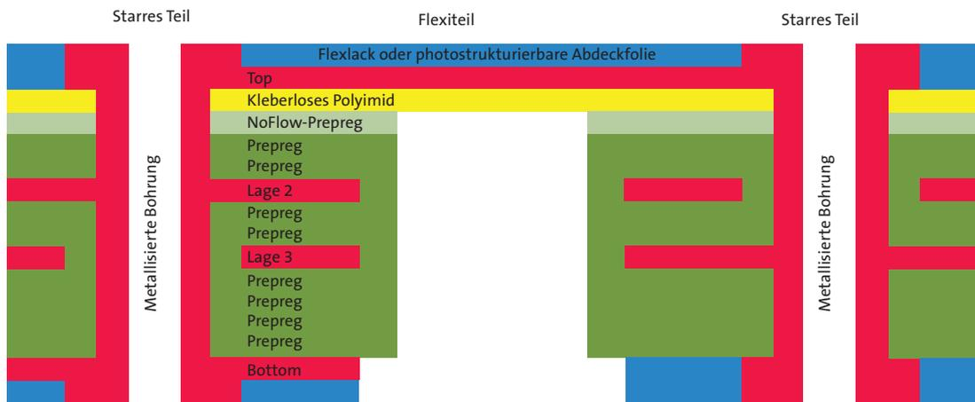
Abb. 1: Musteraufbau eines 4-Lagen-Multilayers mit flexibler Top-Lage
