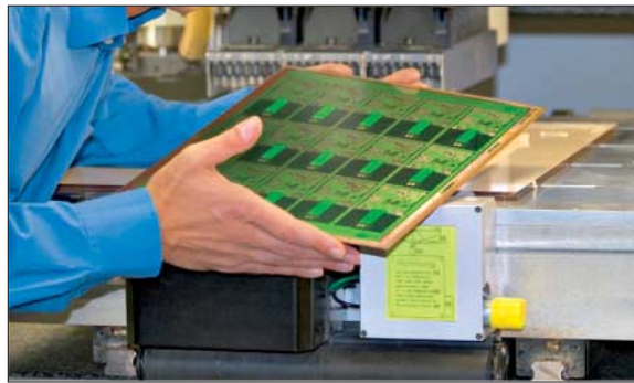
Bild 1: Der Autor mit einer in High Density Interconnect Technik hergestellten Leiterplatte.
