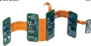
**Starrflexible Leiterplatten kombinieren die Vorteile von starren und flexiblen Schaltungsträgern.**
